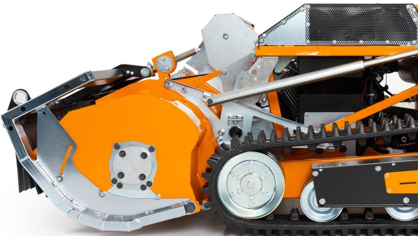
La nueva **AS 1000 OVIS EVO RC** se diferencia del modelo básico en que dispone de un ajuste eléctrico de la altura de corte por control remoto con pantalla y de un embrague de cuchillas electromecánico por control remoto.
